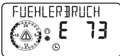
**Hinweis:** Der Fehlercode bezieht sich auf Temperaturfühler, die unter dem Anlagenmenüpunkt TEMPERATUREN abgerufen werden können. Bei einer Störung werden die Fehler nicht in die Fehlerliste, eingetragen. Die Anlage wird nicht abgeschaltet. Nach der Fehlerbehebung erlischt die Anzeige im Display sofort.
